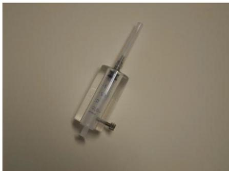
Per iniettare isotopi Gamma emittenti in siringhe monouso in Medicina Nucleare. Realizzate in piombo antimoniale spessore mm 4, a forma cilindrica con foro centrale ed estremità rastremata per un miglior inserimento dell'ago. Sono dotate di popolino per bloccaggio siringa e finestrella in cristallo al piombo Eqpb mm 2.0. Verniciatura con vernici decontaminabili. I popolini ed il vetrino della finestrella sono sostituibili in caso di rottura.
