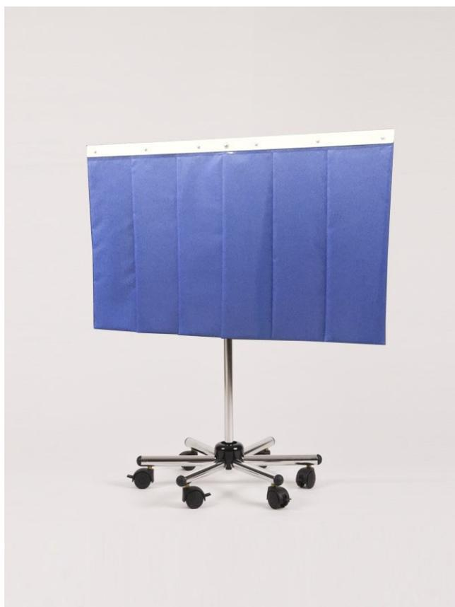
Protezione antix mobile costituita da telo antix Pb mm 0,50 suddiviso in n. 6 strisce in gomma piombifera ricoperta da elegante rivestimento in nylon.
